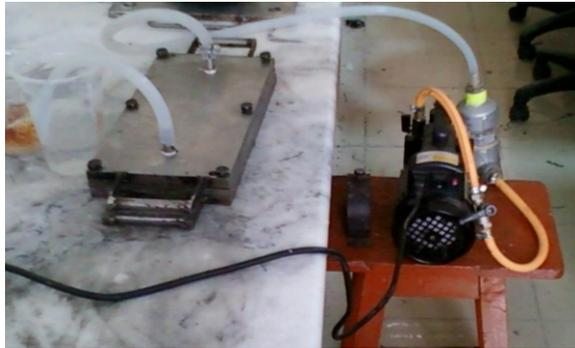
Fig. 5. VARTM setup
